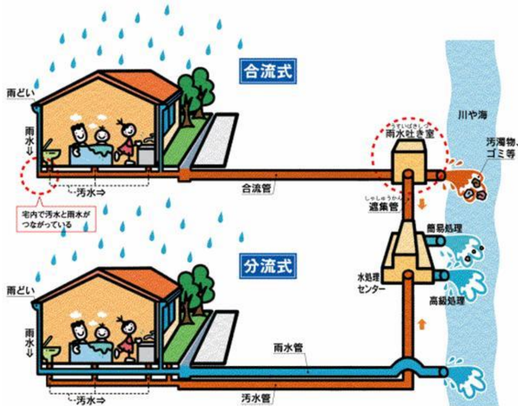
合流式と分流式のイメージ図
