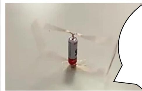
ネオジム磁石・電池・針金を使ったモーター実験の様子。ジェフリーすずかフェイスブックにて動画公開中！
