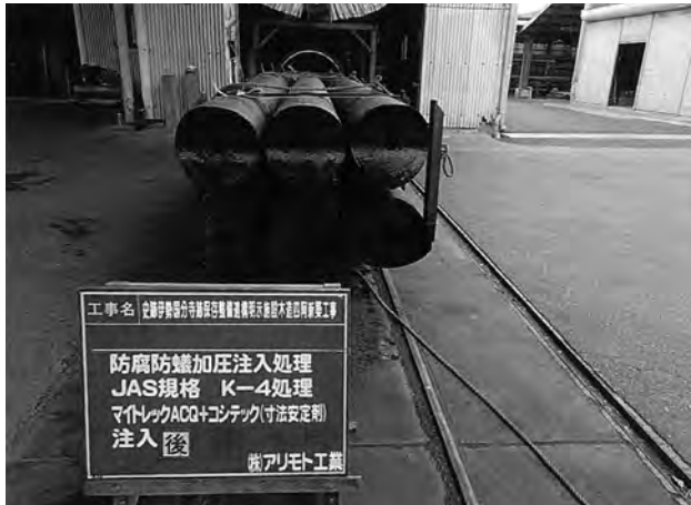
防蟻防腐剤加圧注入完了
