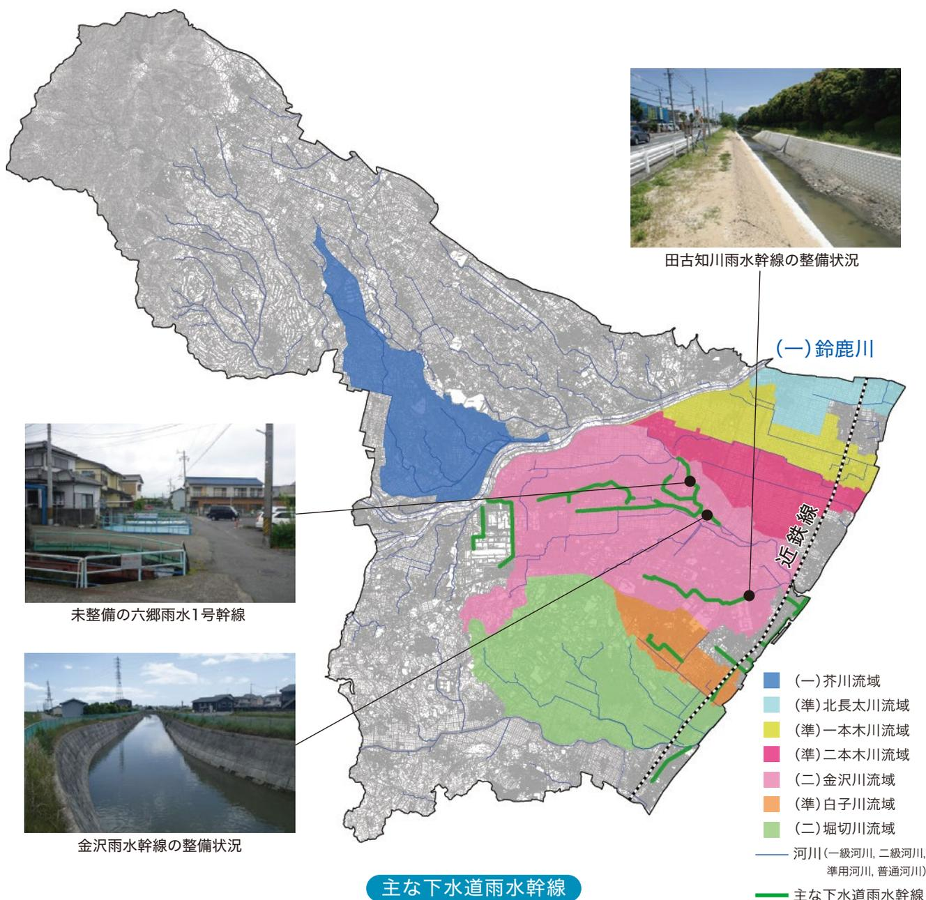
15) 雨水幹線(うすいかんせん)：雨水のみを排除する管渠の中で、主要な管渠のこと。
