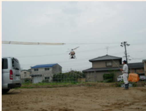
ラジコンヘリで写真を撮って測量します。
