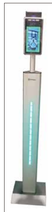
斎苑玄関に設置するサーマルカメラ
