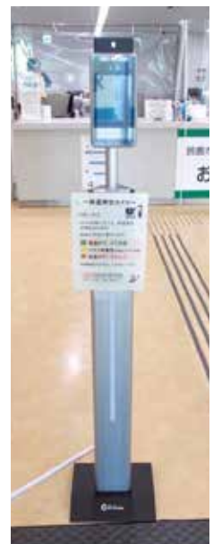
据置式非接触赤外線温度計
