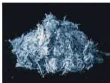
青石綿(クロシドライト)
