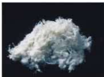
白石綿(クリソタイル)
