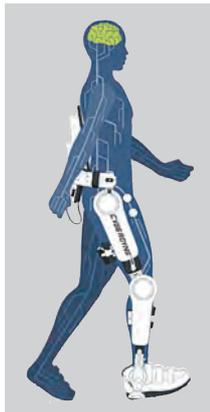
HAL®とは、手や足を動かしたいと考えたときに、脳から出る信号をセンサーで感知し、動きにくくなった部分をアシストして動かす世界初の装着型サイボーグです。
