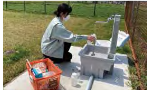
▲水源(深井戸)採水の様子
