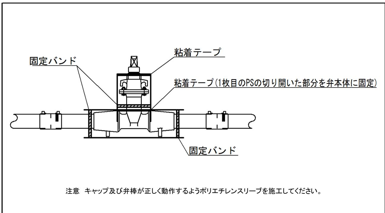
HPPE口径50mm制水弁ポリエチレンスリーブ施工例(模式図)
