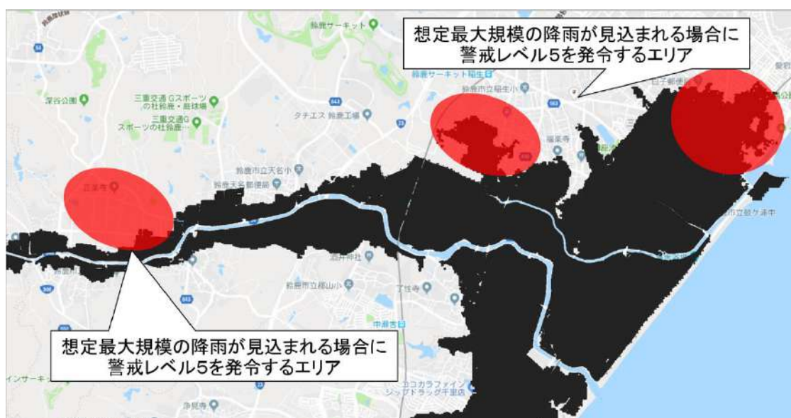
図1-13：【中ノ川】想定最大規模の降雨が見込まれる場合に警戒レベル5を発令するエリア
